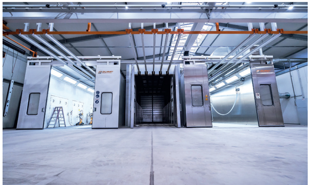
Blick in die neue Lackierhalle. Die Lackiertechnik umfasst eine Strahlkabine, eine Edelstahl-Waschkabine, einen kombinierten Haftwassertrockner und Pulvereinbrennofen sowie eine Großraum-Pulverkabine.
